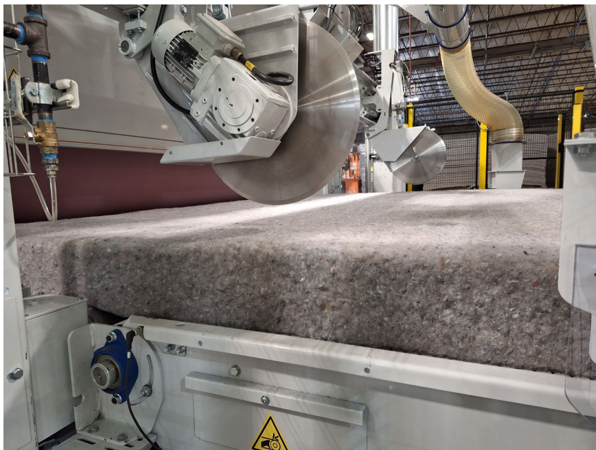
ANDRITZ neXline airway-Anlage in Betrieb bei Carolina Nonwovens
